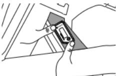
Senza premere il pulsante e con motore al minimo, il dispositivo si accenderà automaticamente dopo circa 8 secondi. Il simbolo della clessidra a lato del display inizierà a lampeggiare, segnalando che il dispositivo sta registrando. **ATTENZIONE:** nel caso lampeggiassero tutte le cifre, il dispositivo sta segnalando una anomalia: in tal caso si prega di contattare il proprio rivenditore.
