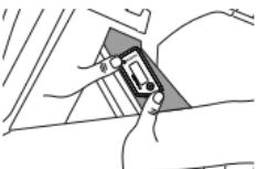
Halten Sie das Gerät mit zwei Fingern fest und lassen Sie den Motor im Leerlauf laufen. Das Gerät schaltet sich nach ca. 8 Sekunden automatisch ein. Das Sanduhr-Symbol auf der linken Displaysseite beginnt zu blinken. Dies bedeutet, dass das Gerät zu zählen begonnen hat.
