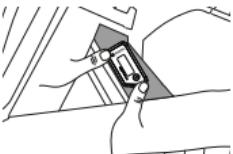
O dispositivo ligará automaticamente após cerca de 8 segundos. O ícone de ampulheta no lado esquerdo do visor começará a piscar. Isso significa que o dispositivo começou a contar. **ATENÇÃO:** todos os dígitos piscarão se o dispositivo detetar uma anomalia. Entre em contato com seu concessionário caso isso aconteça.
